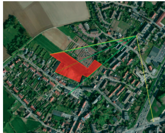
Fig. A.3.3 Détermination de la catégorie de rugosité du terrain à partir d'une photo aérienne.
